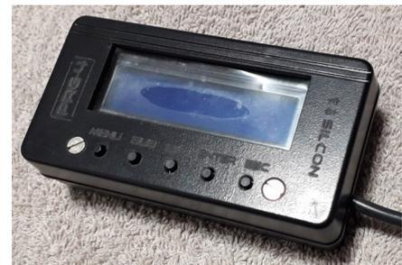
**TECLA MENU:** Manteniéndola presionada por 5 segundos se ingresa al menú de programación. Si no está activo el menú programación, permite cambiar entre las siguientes opciones: estado actual de la escalera, histórico de las ultimas 18 fallas, activación de funciones especiales.
